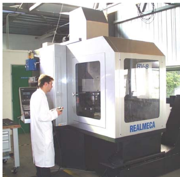
Exemple d'intégration du procédé de Stratoconception® sur machine 3 axes REALMECA RV8 avec commande numérique SIEMENS
